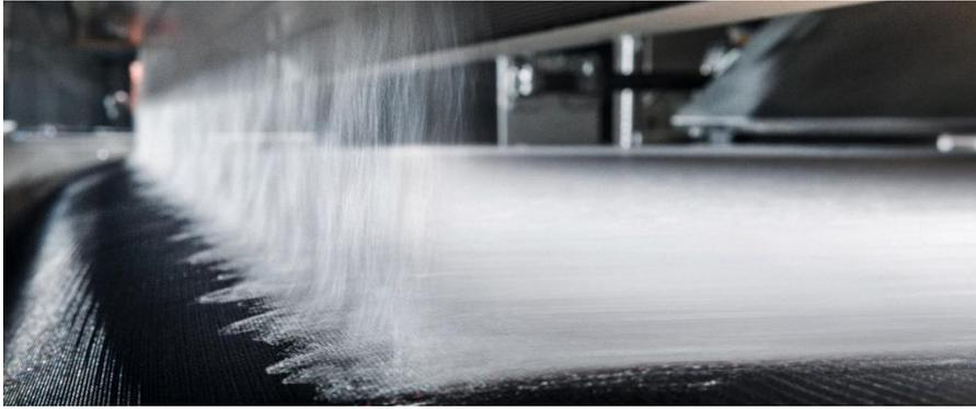
Bild 6: Wolf PVG hat mit dem Supercharged Meltblow-Verfahren eine Spitzentechnologie weiterentwickelt und damit die Filterleistung von Staubsaugerbeuteln noch einmal deutlich steigern können. ©Melitta Group
