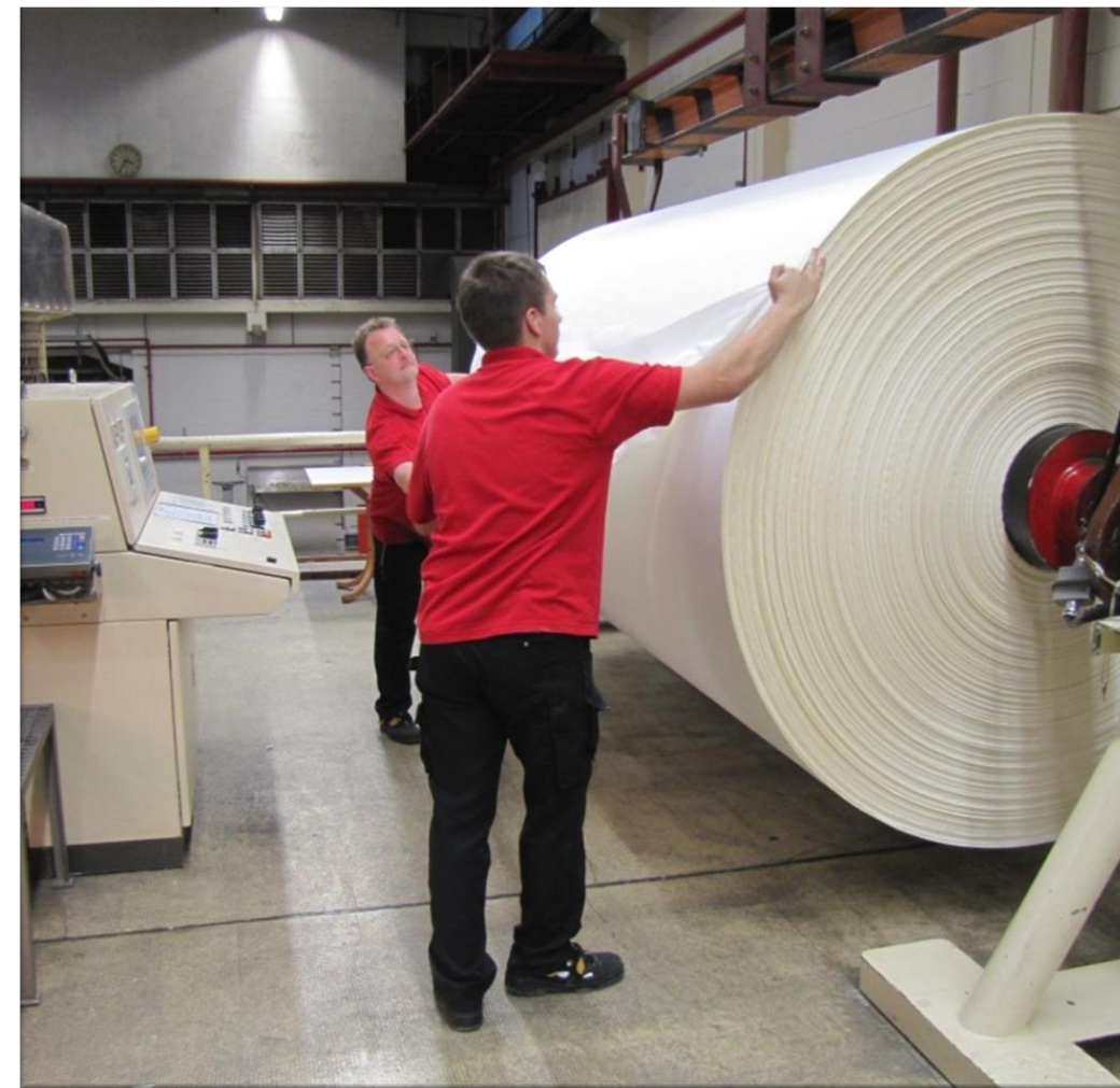
Abb.: Tambourwechsel am Umroller der Papierherstellung
