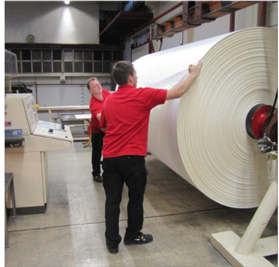
Abb.: Tambourwechsel am Umroller der Papierherstellung
